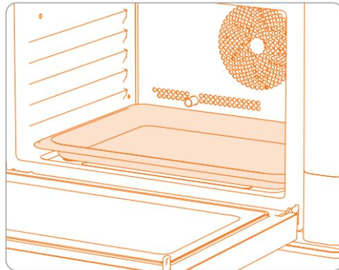
**Abbildung 2:** Positionierung der Schale während der Entkalkung
