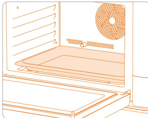
*figura 2: colocación de la fuente durante la descalcificación*
